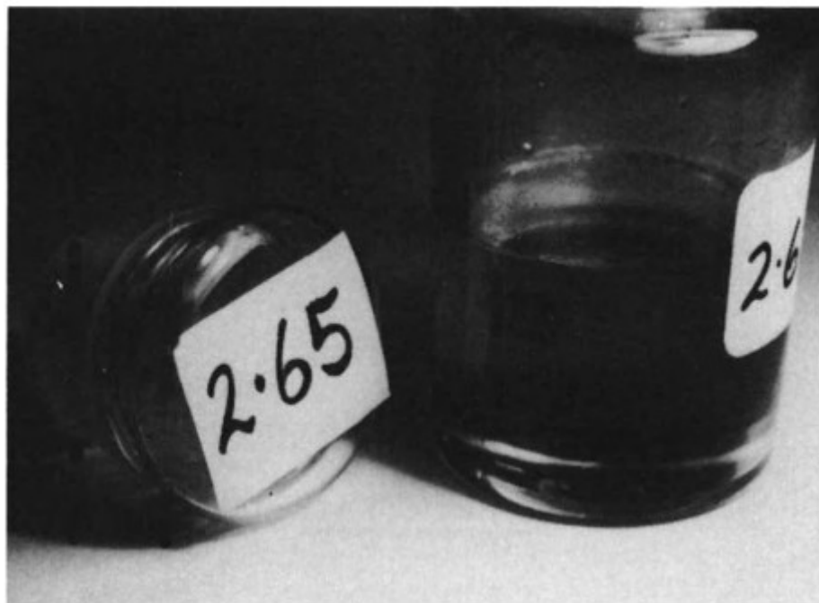
Fig. 5.4. Överst: ett okänt ädelstensexemplar tappas i en flaska tung vätska med ett SG på 2,65. Nederst: det okända ädelsten flyter fritt i vätskan, vilket bekräftar att det är en av kvartssorterna
