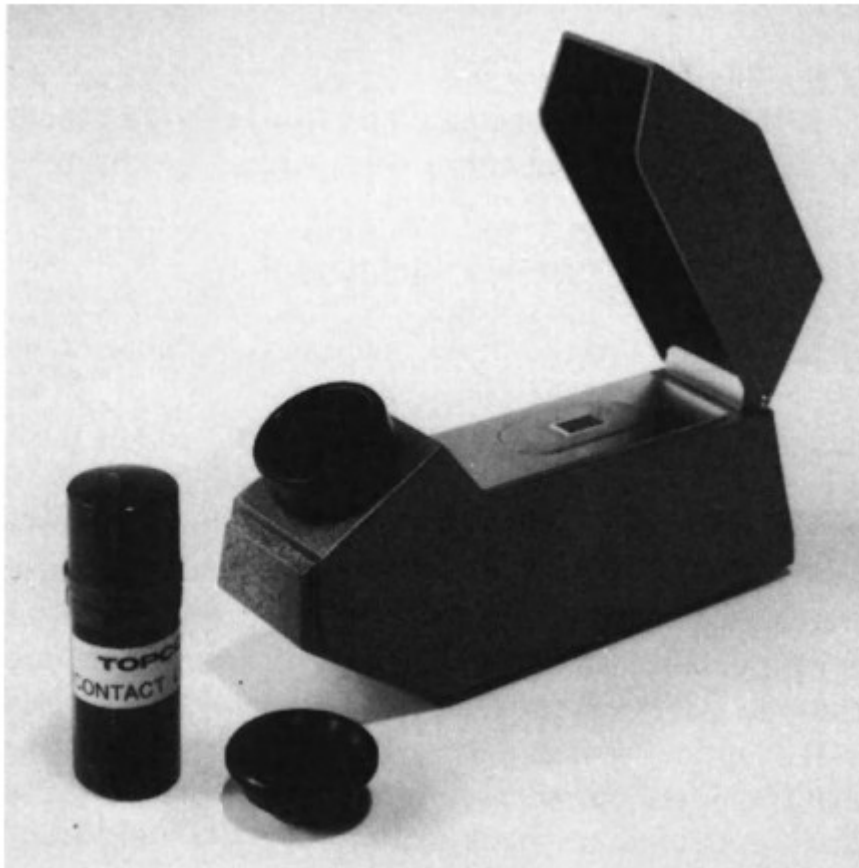
Fig. 6.5. En standard kritisk vinkelrefraktometer med kontaktvätska och polariseringsfilter. (Gemmological Association of All Japan)
