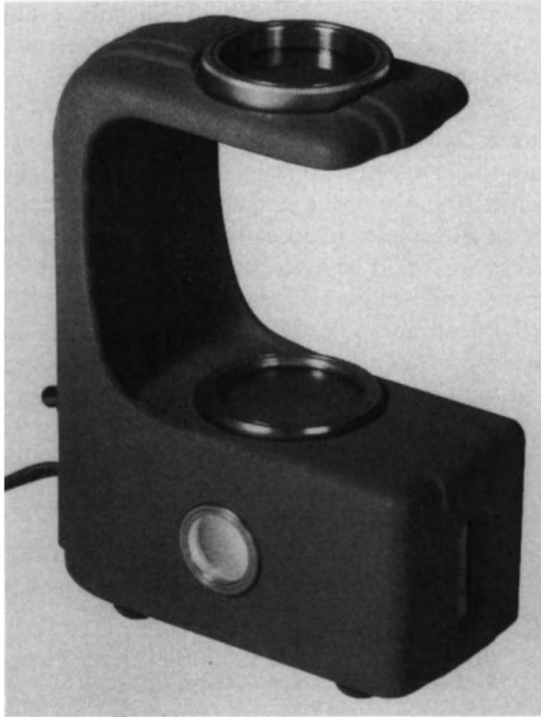
Figur 6.10. Polariskopet "Illuminator" använder två polariserande filter fixerade i utrotningsposition. Öppningen framtill kan användas för att ge en vit ljuskälla för en refraktometer (Gem Instruments Corporation).
