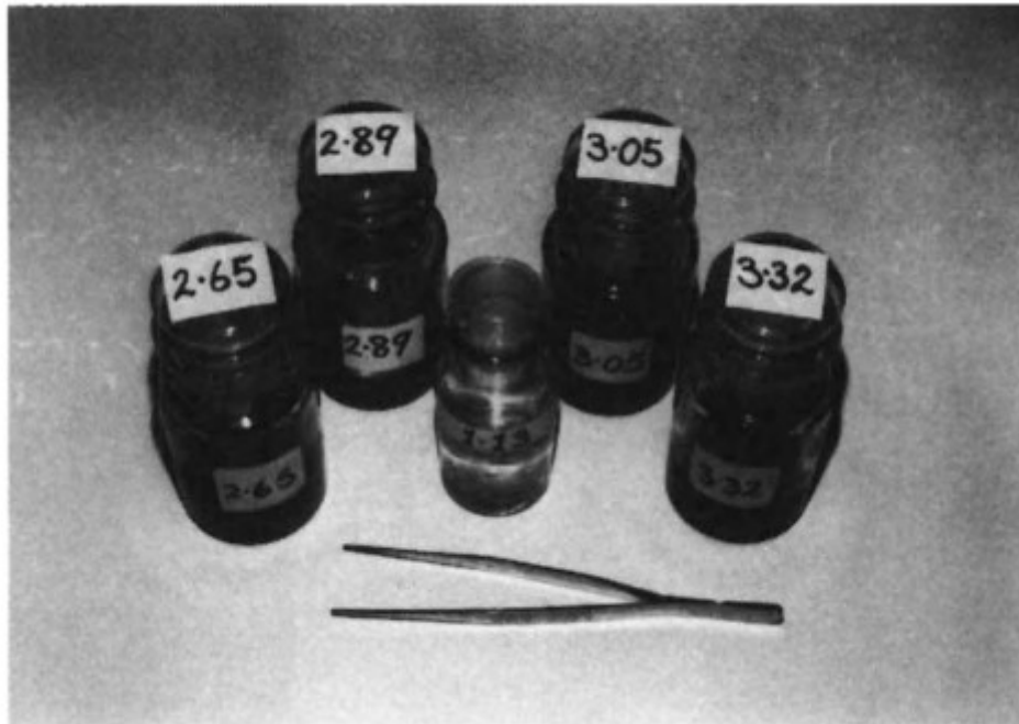
Fig. 5.3. En uppsättning tunga vätskor som används för att uppskatta det specifika gravitationen av ädelstenar. Flaskan i mitten innehåller ett salt lösning som används för att testa bärnsten
