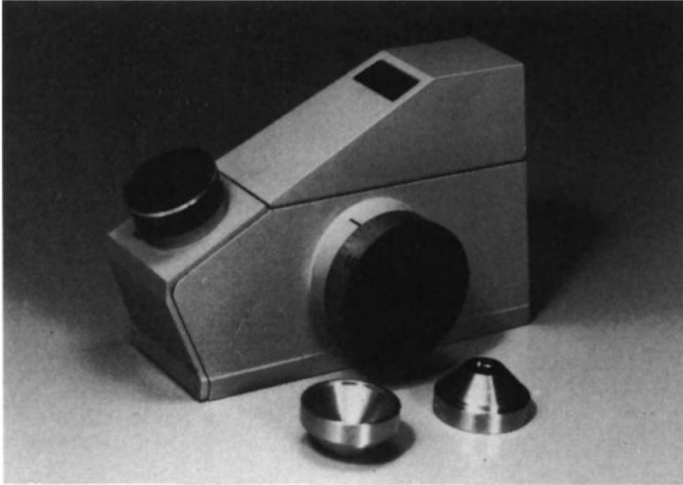
Fig. 6.8. Rayners 'Dialdex' refraktometer. Istället för en skala markerad med RI-värden använder detta instrument en kalibrerad kontrollknapp för att justera ett svart band med den projicerade skuggstrecket. (Gemmological Instruments Ltd.)
