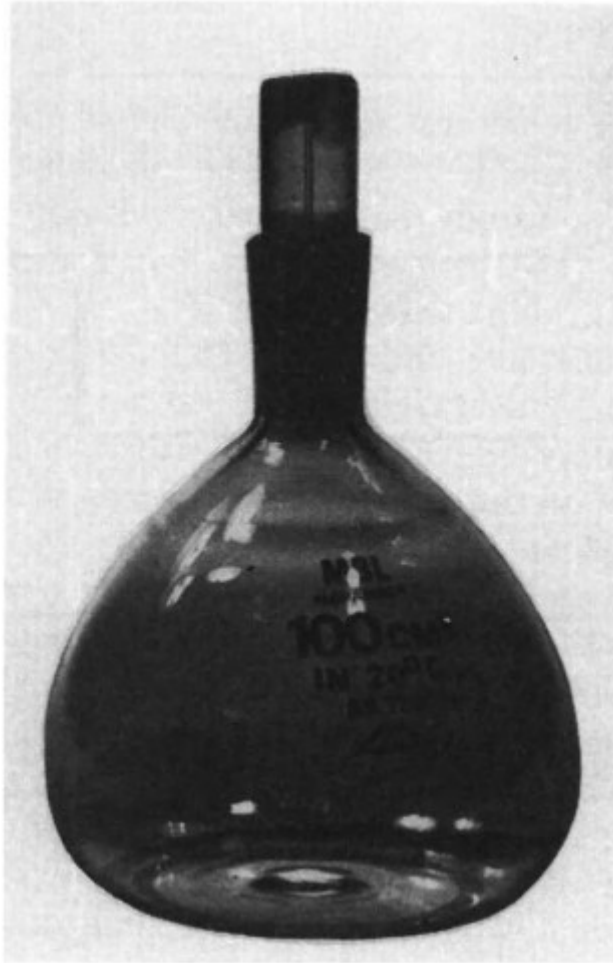
Fig. 5.6. En "densitetsflaska" för det exakta bestämning av specifik vikt med hjälp av blandade tunga vätskor (Baird och Tatlock)
